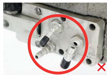
Sérült / hiányzó üzemanyag-beömlőnyílás
